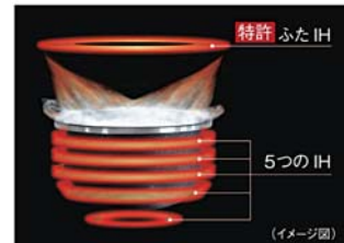
図4 IH コイルは内釜を包み込むよう6段に配置
